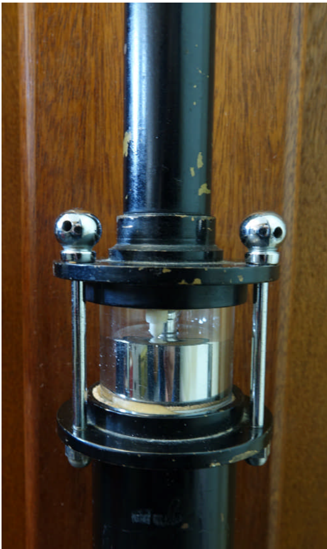
R7 Das Schauglas mit dem kleinen weißen Index, der gerade die Quecksilberoberfläche berühren soll. Zum Ablesen des Barometers muss die untere Schraube so weit heraus oder hinein gedreht werden, dass der Index mit seinem Spiegelbild auf dem Quecksilber ein X ergibt.
