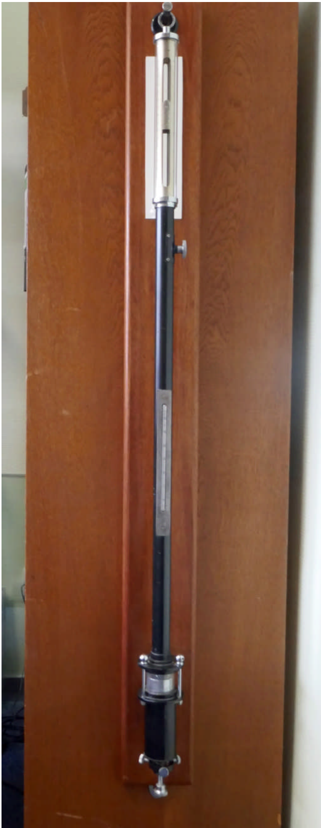
R4 Das komplette Barometer. Am unteren Ende die Einstellschraube und Transportsicherung
