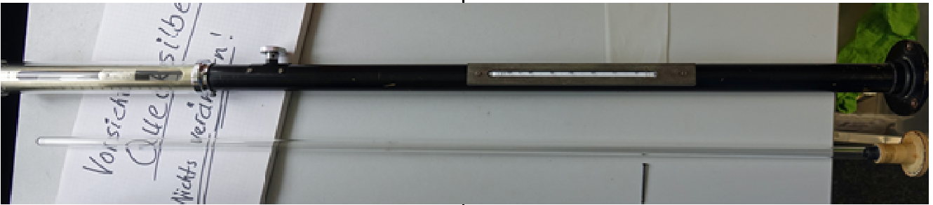
R6 Die Seele des Barometers, das lange Glasröhrchen, Kapillare genannt, liegt hier ausgebaut unterhalb des Barometer-Rohres, das weitgehend aus Metall besteht. Angeklebt sieht man ein Holzteil welches das (siehe R7) Schauglas nach oben hin abschließt.
