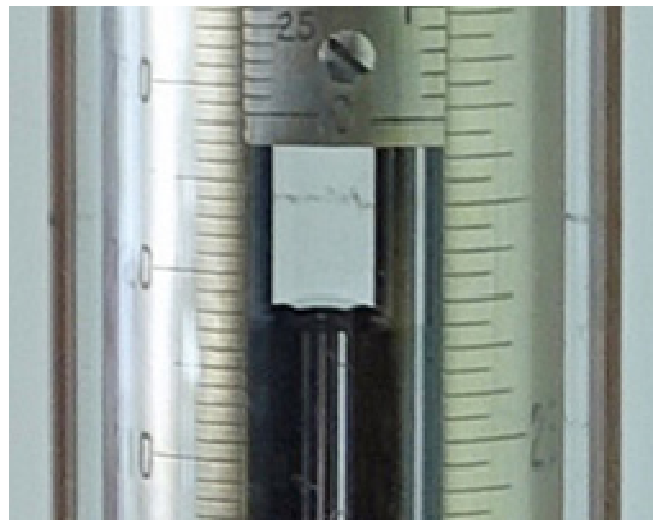
R5 Nach dem Wiederbefüllen stand der Pegel bei 718 mm, also deutlich höher als vorher, aber immer noch viel zu niedrig. Normal wäre ein Pegelstand zwischen 740 und 780 mm gewesen.
