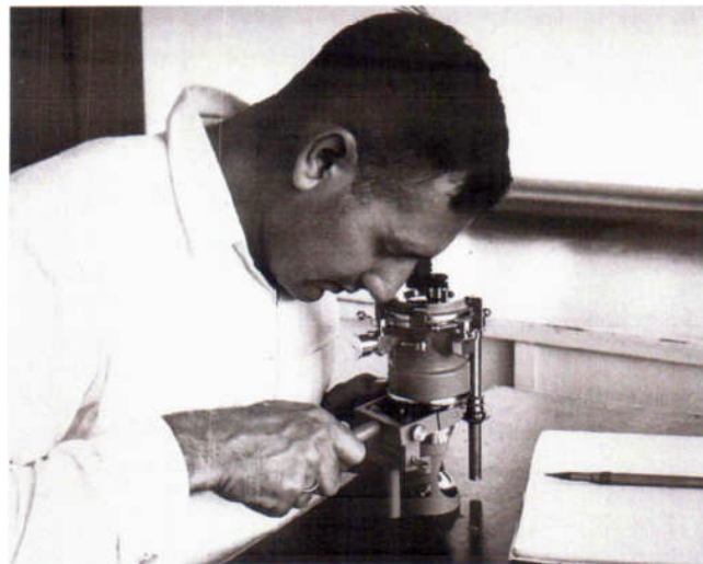
Abbildung 10-2. Arbeit mit dem Coniometer zur Bestimmung der Luftqualität.
