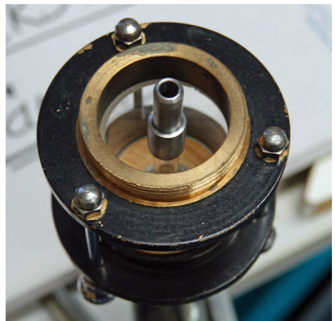
R11 Auf das Kapillarenende lose aufgesetzte Stahlverlängerung
